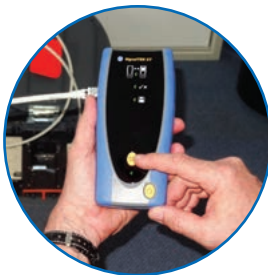
Autotest-Funktion über Remote-Gerät für Ein-Mann-Betrieb
