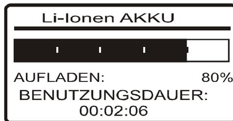
Ist der Akku vollständig geladen, schaltet das Gerät automatisch ab, es ertönen zwei akustische Signale und das Display zeigt an, wie lange die Ladung gedauert hat.
