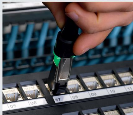
Dans des pièces avec des serveurs bruyants, les indications lumineuses permettent d'identifier immédiatement le statut du test réalisé au lieu de se fier au simple signal sonore que proposent les autres certificateurs.
