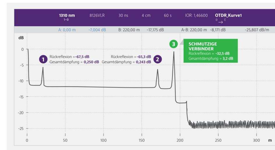
Diese ODR-Kurve zeigt, wie ein verschmutzter Steckverbinder die Gesamtsignalleistung beeinträchtigt. **Führen Sie daher immer zuerst eine Sichtprüfung durch!** Die vorbeugende Prüfung aller optischen Steckverbindungen verringert Ausfallzeiten im Netzwerk sowie den Aufwand zur Fehlerbehebung deutlich.
